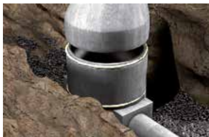
Sigillatura anelli di pozzetti di calcestruzzo
