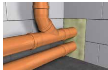
Riempimento di attraversamenti di tubazioni
