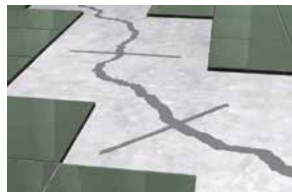
Sigillatura di fessure
