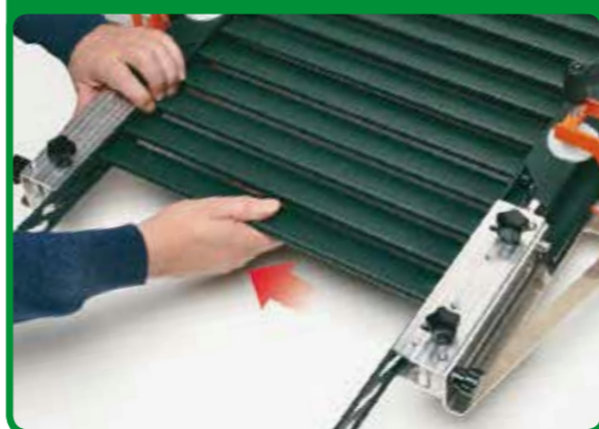
2 - Inserisco la lamella nell'asola sinistra
