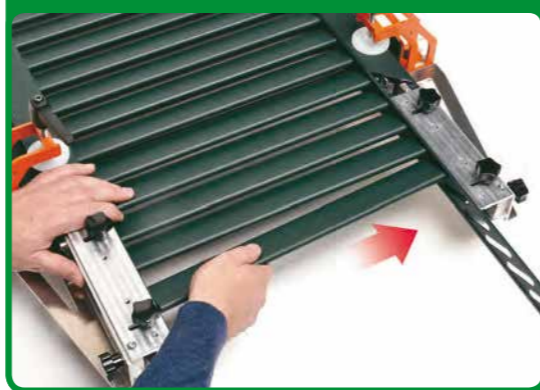
1 - Inserisco la lamella nell'asola destra
