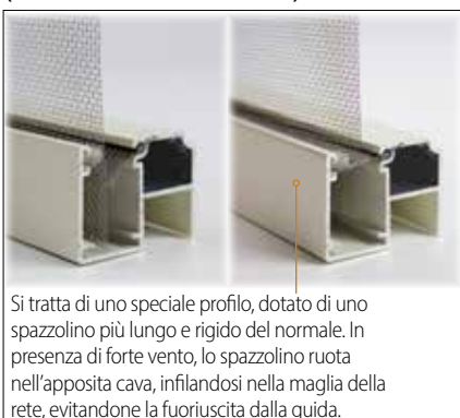
Guida con sistema antivento (brevetto internazionale Bettio)
